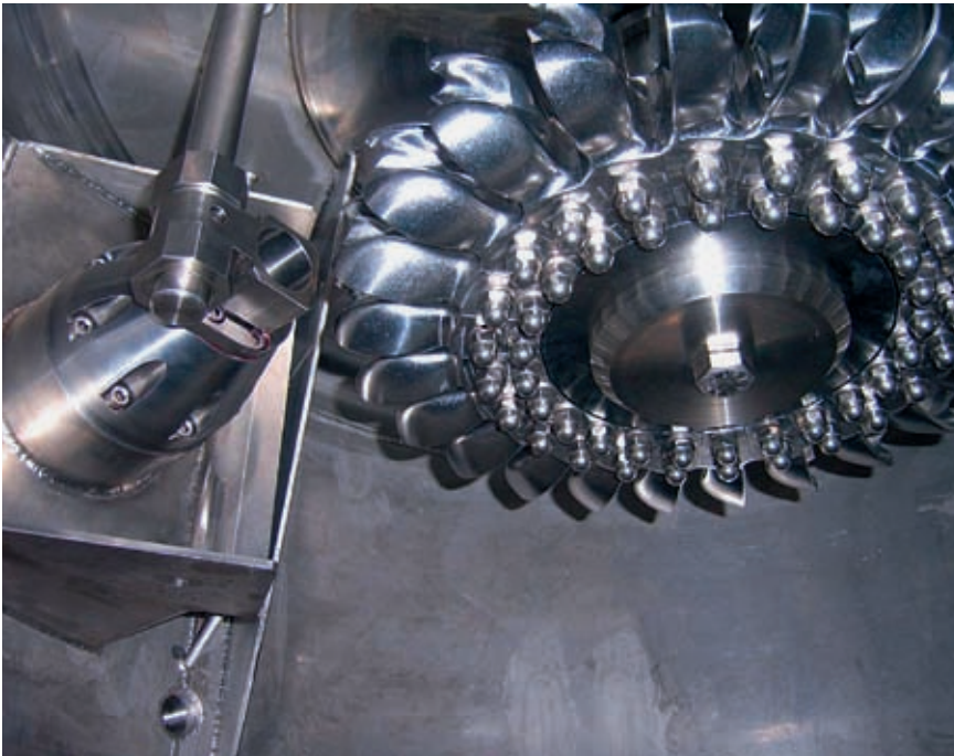
Bild 6: Die komplett in Chrom-Nickelstahl gefertigte Turbinenteile
